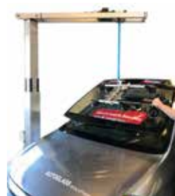
K4650 Rudekran for personbil / varevogn max 80 kg
